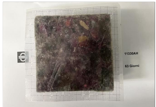
Grado di carbonatazione dopo 63 giorni
