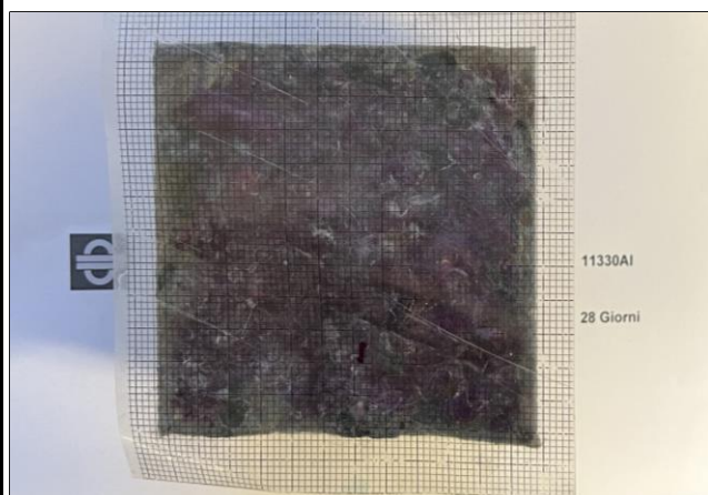
Grado di carbonatazione dopo 28 giorni
