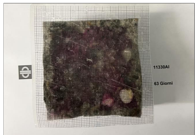
Grado di carbonatazione dopo 63 giorni
