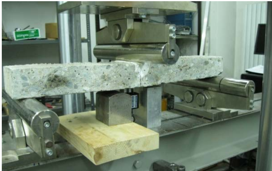
Figura 2. Set-up prova di flessione su tre punti
