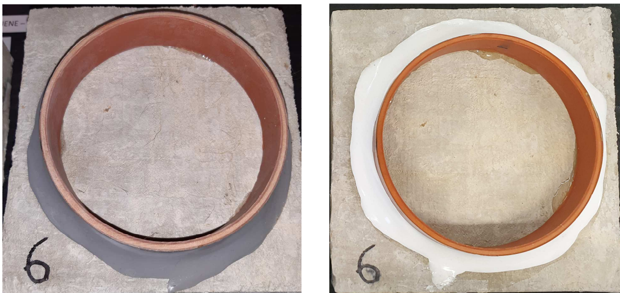
Figura 1 - Campione 11330AA prima (sinistra) e dopo (destra) l'esposizione a soluzione al 50% - 50% in volume di TOLUENE + TRIMETILPENTANO N.B. il campione è stato ulteriormente sigillato
